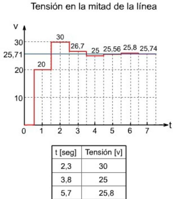
5) La tensión de una fuente de cc se aplica a una línea de transmisión aérea cerrando un interruptor. El extremo receptor de la línea está conectado a un cable subterráneo. Considerar a ambos como ideales y como tensión inicial en la línea igual a  $v^+$ .
